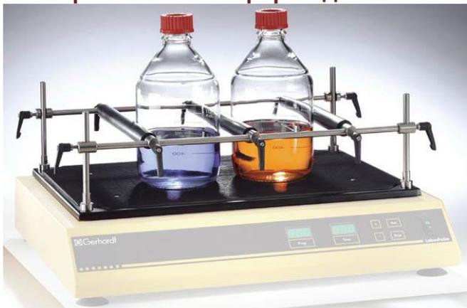
Приспособление поставляется в виде комплекта, включающего 2 фиксирующих стержня, прикрепленных к вертикальным штырям на желаемой высоте. Зажимные валики, покрытые Neoprene, позволяют размещать на платформе сосуды разного объема и конфигурации. Для специальных применений можно дополнительно установить стабилизационные продольные или поперечные стержни.
